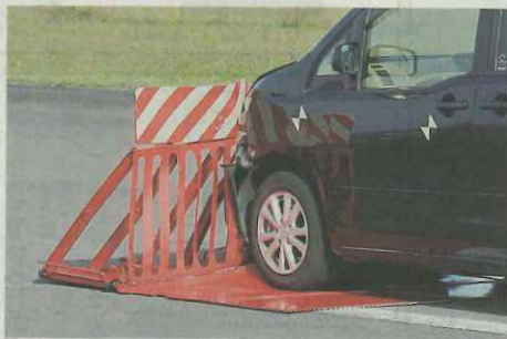
試作品の柵に、高速走行 する車を衝突させた実証 実験（阿部裕貴撮影）
