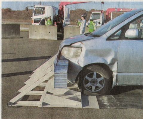
衝突試験で車の進入を阻止したバリケード。昨年11月
